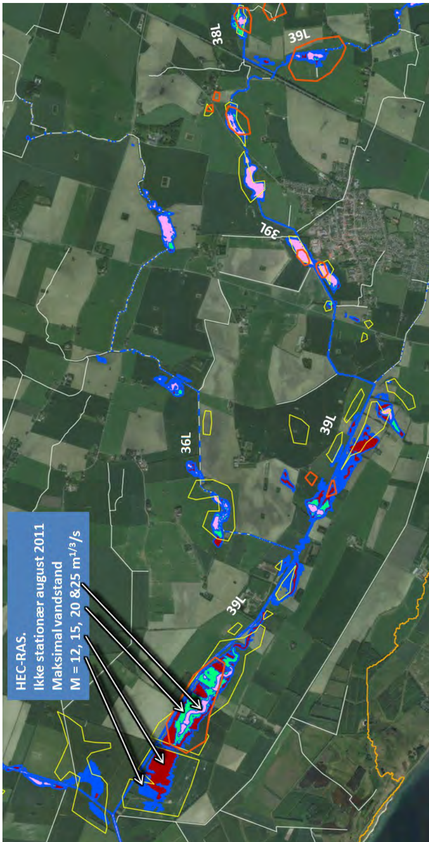
Figur 108: Ikke stationære HEC-RAS simuleringer, hvor udbredelser af oversvømmelse i forhold til anvendelse af forskellige Manningtal er vist med forskellige farver. Den observerede udbredelse af oversvømmelse i august 2011 er vist med orange polygon og udbredelse af vinter oversvømmelse 2010 er vist med gule polygoner.
